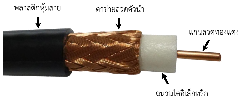
ภาพที่ 3.8 ลักษณะโครงสร้างสายโคแอกซ์
