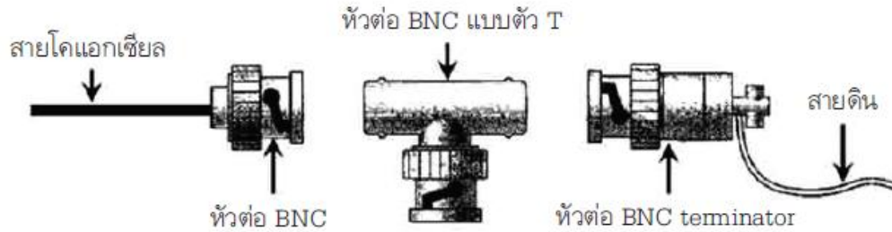
ภาพที่ 3.11 ลักษณะของหัวต่อ BNC แบบต่างๆ สำหรับสายโคแอกเซียล ที่มา: มหาวิทยาลัยสุโขทัยธรรมาธิราช. (2554 : 3-17)
